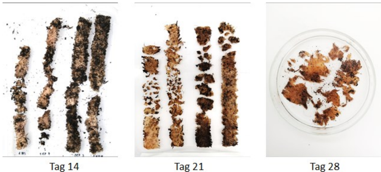
Abbildung 5: Zustand der Stoffproben nach 14, 21 und 28 Tagen im Erdeingrabetest
