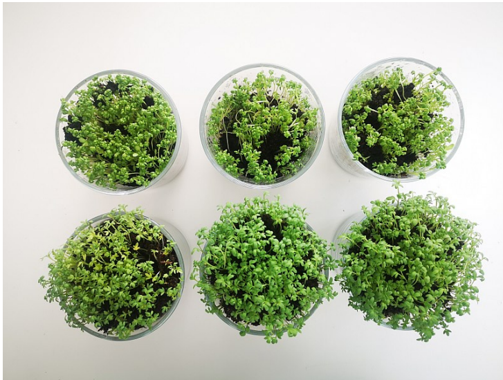
Abbildung 16: Offener Kresstest - obere Reihe: Kontrolle, untere Reihe: Testsubstrat
