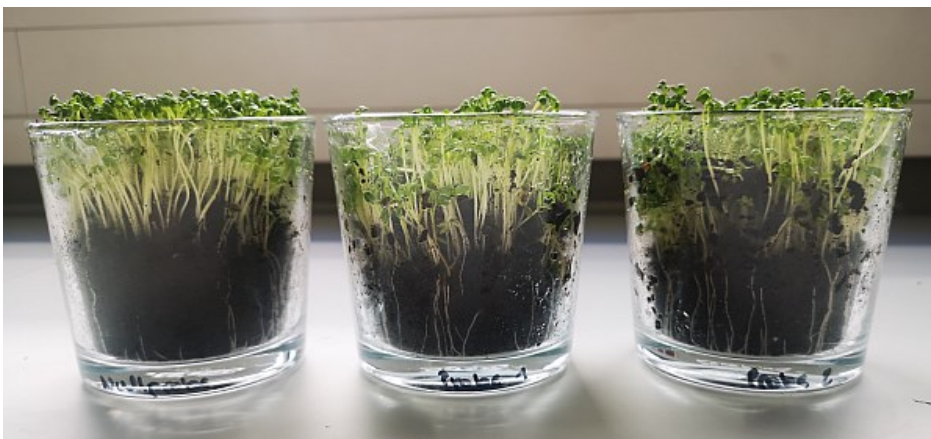
Abbildung 17: Ergebnis des geschlossenen Kresstests – Links: Kontrolle, Mitte und rechts: Testsubstrat
